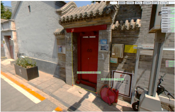
基于全景视频流的三维量测
